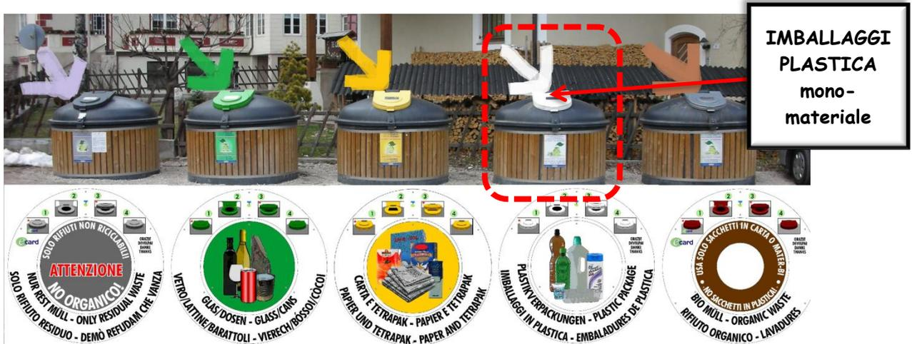
Infine, nei Comune di Pozza di Fassa, Vigo di Fassa e Campitello, in via sperimentale, sono stati installati anche dei seminterrati per la raccolta degli imballaggi di plastica (bottiglie e flaconi).
